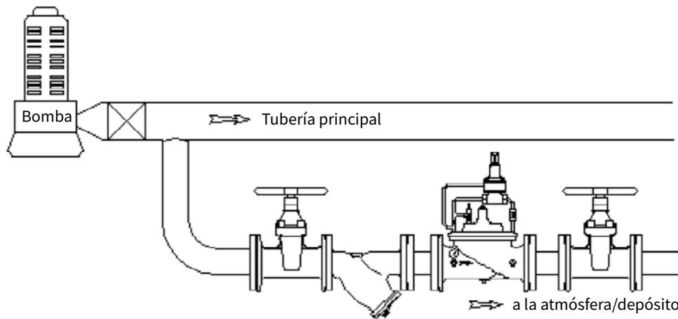
Apertura rápida y cierre lento, para proteger la instalación de posibles sobrepresiones por parada de bomba, golpes de ariete, etc, abriendo en derivación y disipando el exceso de presión.
