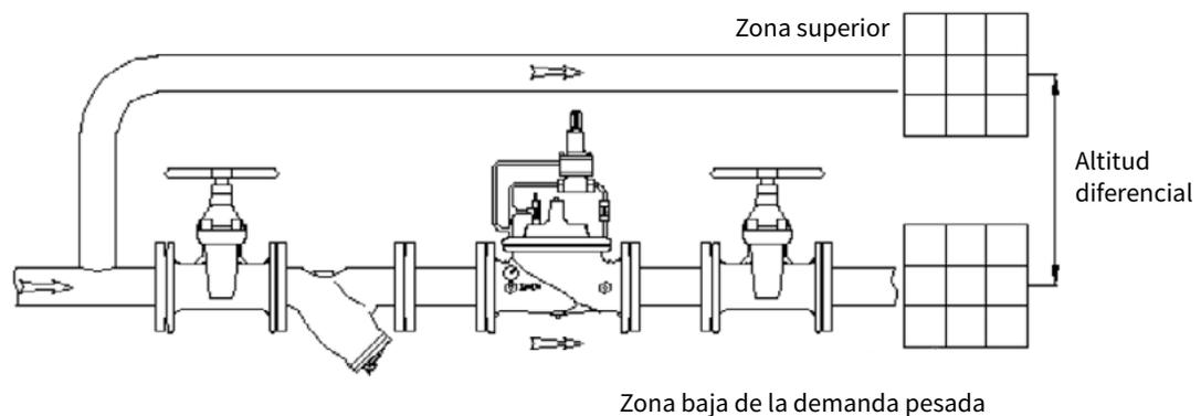
Se instala la válvula en la zona de cota inferior para restringir y mantener una presión uniforme aguas arriba que permita que no caiga la presión en las zonas altas. Conservando la presión tarada, la válvula permitirá el paso del exceso que se produzca.
