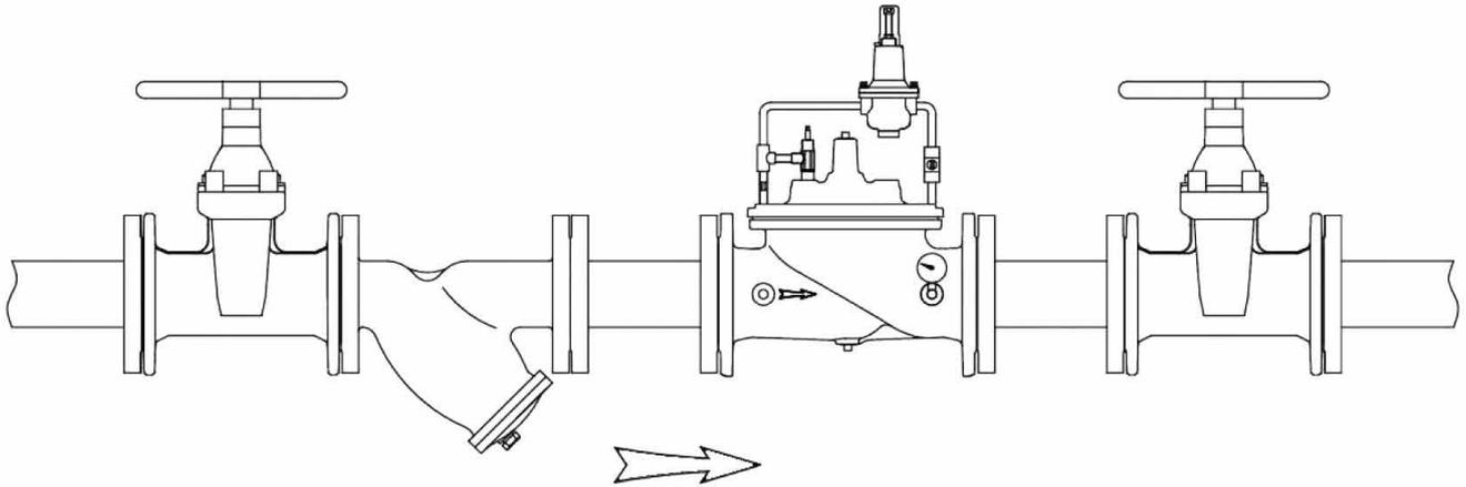
Para poder llevar a cabo la puesta a punto y mantenimiento de una válvula hidráulica, es fundamental la instalación de los siguientes elementos:
