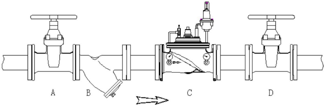
Pour permettre la mise au point et l'entretien d'une vanne hydraulique, il est essentiel d'installer les éléments suivants:
