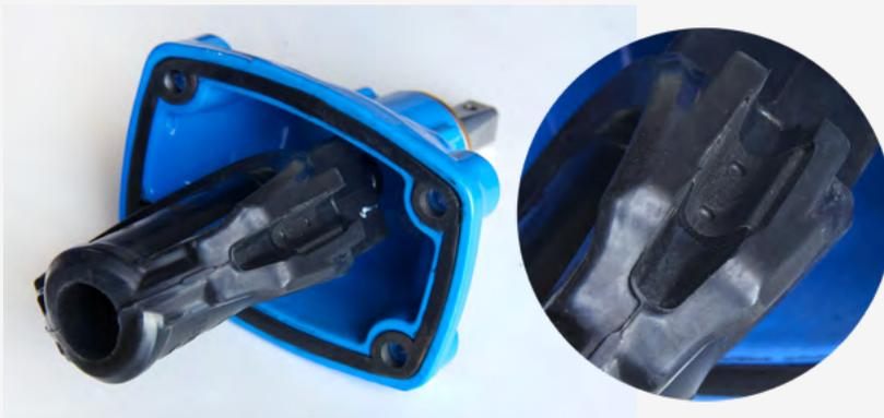
La incorporación del patín de nylon evita la fricción entre la compuerta y la guía de la válvula reduciendo el desgaste y eliminando adherencias calcáreas que puedan acumularse en el eje. Esto protege el caucho vulcanizado de la compuerta y evita fricciones con los elementos de fundición, aumentando la vida útil del sistema.
