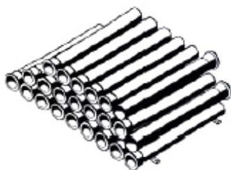
En la práctica este es el método más interesante desde el punto de vista de la seguridad, coste de maderas y cuñas y número de tubos acopiados por volumen de apilado. Este método requiere manipular los tubos por los extremos, mediante el uso de múltiples ganchos para poder manipular varios tubos a la vez.
